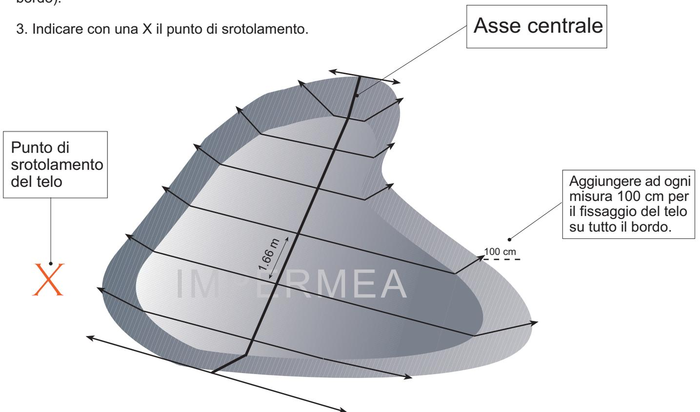
Annotare sulla pianta di misurazione le misure degli assi perpendicolari all'asse centrale. Le misure devono essere prese ogni 1.66 m, come da esempio.
